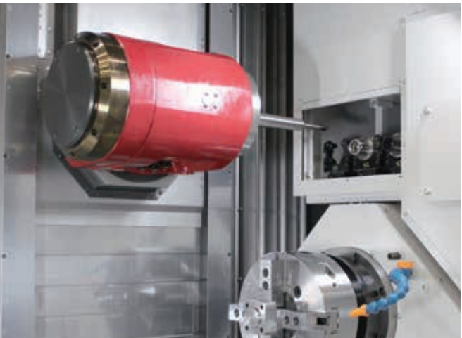
TMX-4000 可从后部进行工具交换， TMX-2000 可从正面进行工具交换。 (图片：80 ATC 规格)
