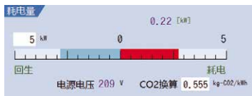
实时显示耗电量和回生电量
