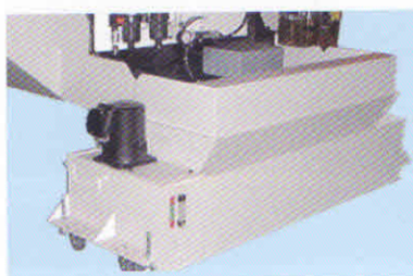
切削液装置（水槽部分）
