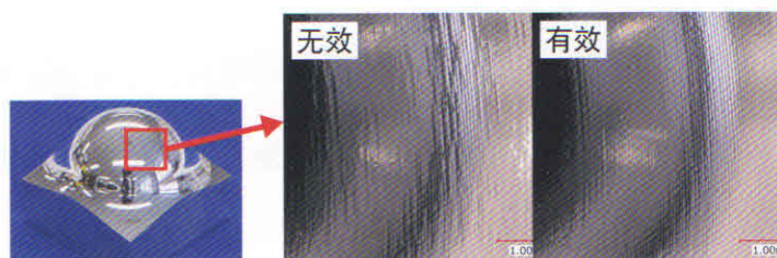
高精度程序指令的应用实例 ※指令单位为 0.1\mu\text{m} 的程序
